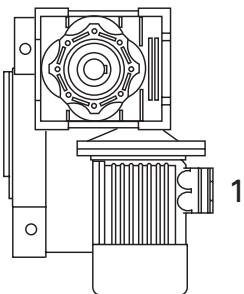
L'esecuzione determina la posizione di montaggio del 1° riduttore rispetto al 2° riduttore. Se non diversamente specificato in fase d'ordine il gruppo viene fornito in esecuzione OBS. La posizione di piazzamento va riferita al 2° riduttore.
